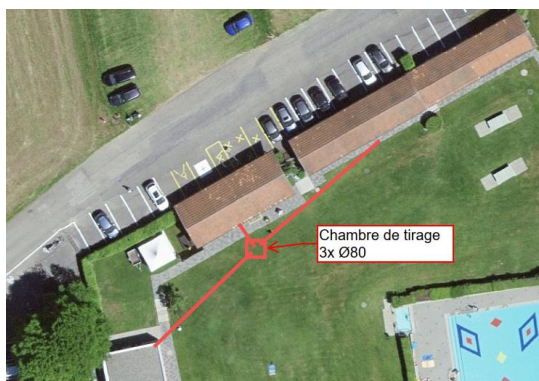
Figure 18 - Plan de situation de la tranchée
